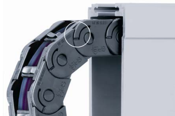
Илл. PM1905-01: igus ООО, Кельн: „Micro Flizz“ для МОС: как только энергоцепь сгибается по радиусу, крылышки переходят в плоское положение. Цепь может выйти из пазов и лечь в нужное положение.
