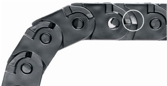
Илл. PM1905-02: igus ООО, Кельн: В растянутом состоянии по бокам на несколько миллиметров выдвигаются крылышки и удерживают всю энергоцепь надежно в направляющем канале.
