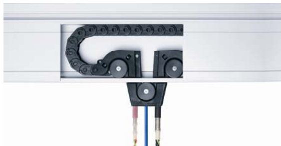
Илл. PM1905-04: igus ООО, Кельн: У нового „Micro Flizz“ фирмы igus нижняя и верхняя часть, экономя вес, разделены друг от друга. На сегодняшний день система допускает скорость до 6 м/с при непрерывной эксплуатации.
